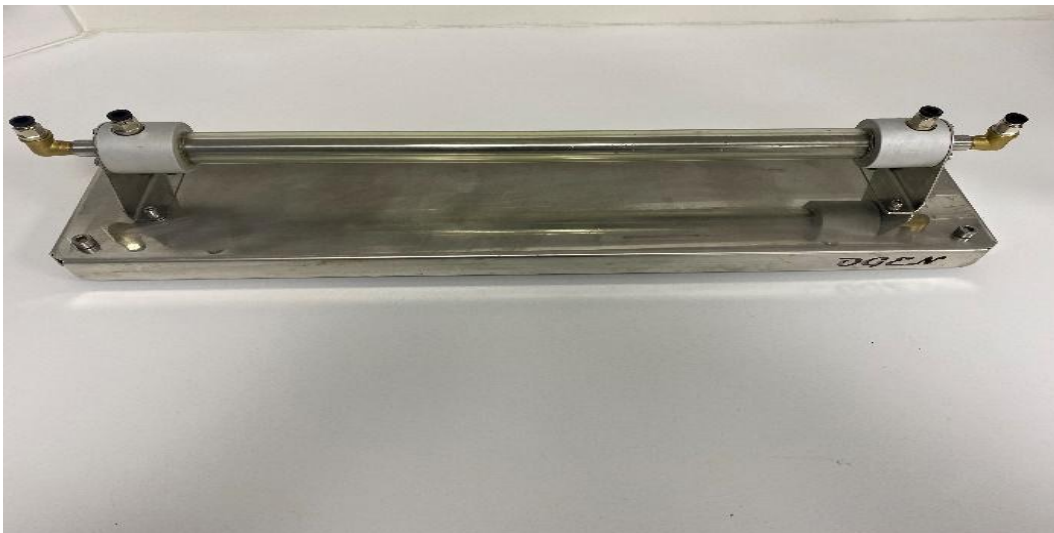
Şekil 1. Çift borulu ısı değiştiricisi deney düzeneği
