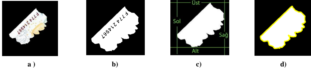
Şekil 5. Parça görüntüsü (b) Otsu metodu ile ikili hale getirilmiş görüntü (c) Görüntüde boşlukların doldurulması ve 4 farklı teğet çizgi çekilmesi (d) Parça sınırının (sarı renk) tespit edilmesi
