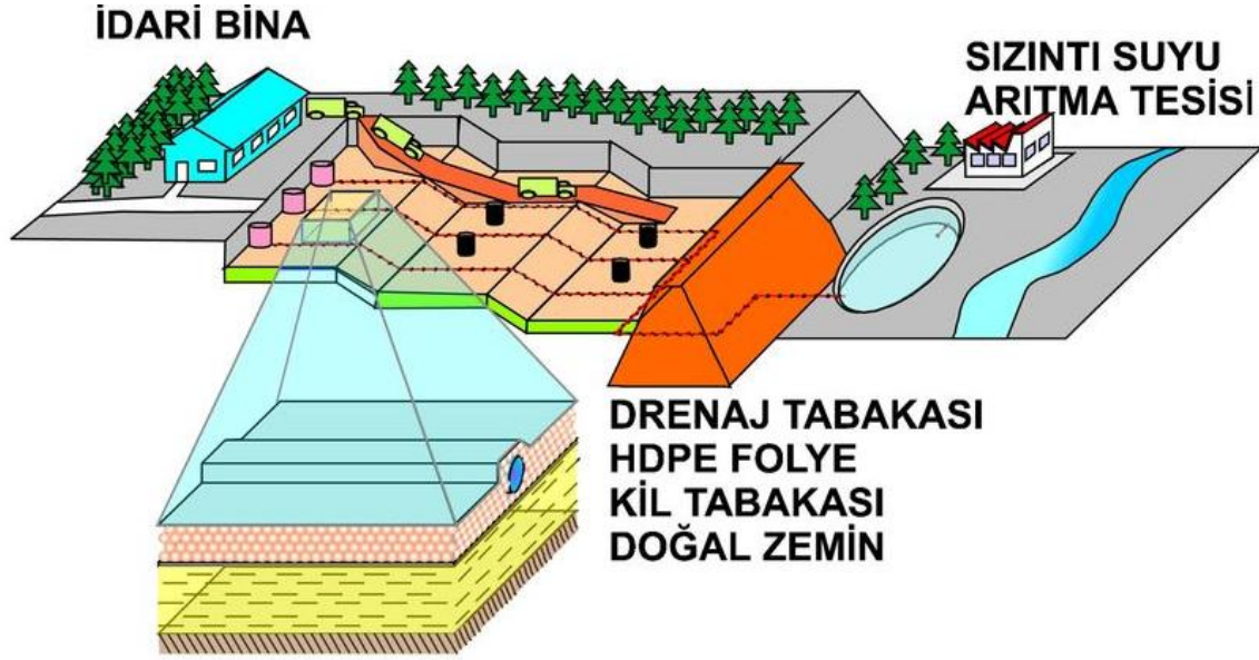
Şekil 1. Örnek sızdırmazlık teşkili (Link 4)
