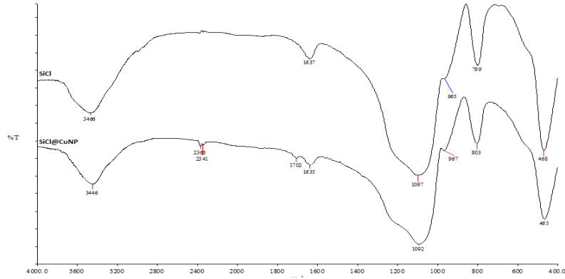
Şekil 2. SiCl ve SiCl@CuNP'lerin FTIR spektrumları
