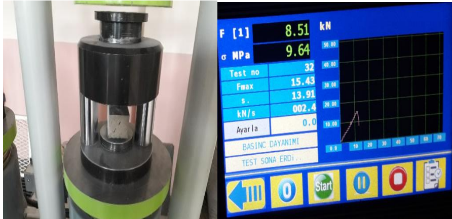
Şekil 2.3. Basınç dayanım testleri
