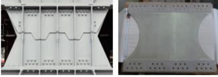
Şekil 2.1. YMÇ'den imal edilmiş sismik damper (Sawaguchi, Maruyama, Otsuka, Kushibe, Inoue, Tsuzaki, 2016).
