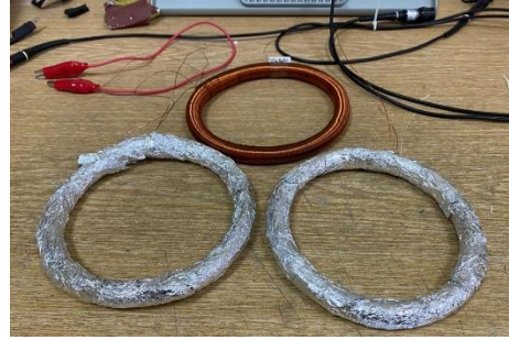
Şekil 6: Üretilen RBlerin son görüntüsü ve ekranlama
