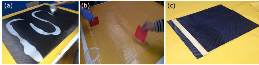
Şekil 2.2 Laminat üretim aşamaları a) Karbon tabaka b) Cam tabaka c) Birleştirilmiş laminat malzeme
