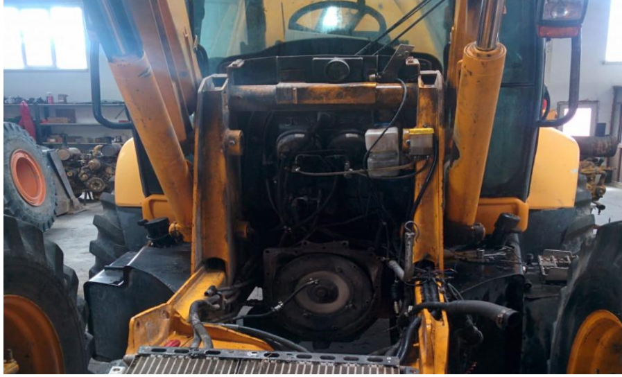
Şekil 2.2.1.3 Motoru sökülmüş iş makinasının önden görünüşü.
