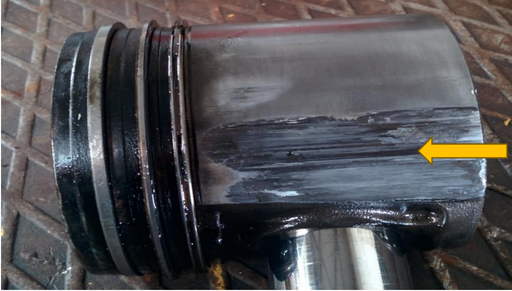
Şekil 2.2.1.1 Aşınmış motor pistonu
