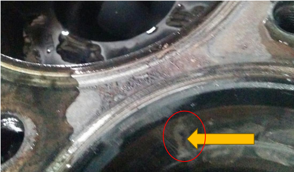
Şekil 2.2.1.2 Çatlak motor silindir gömleği
