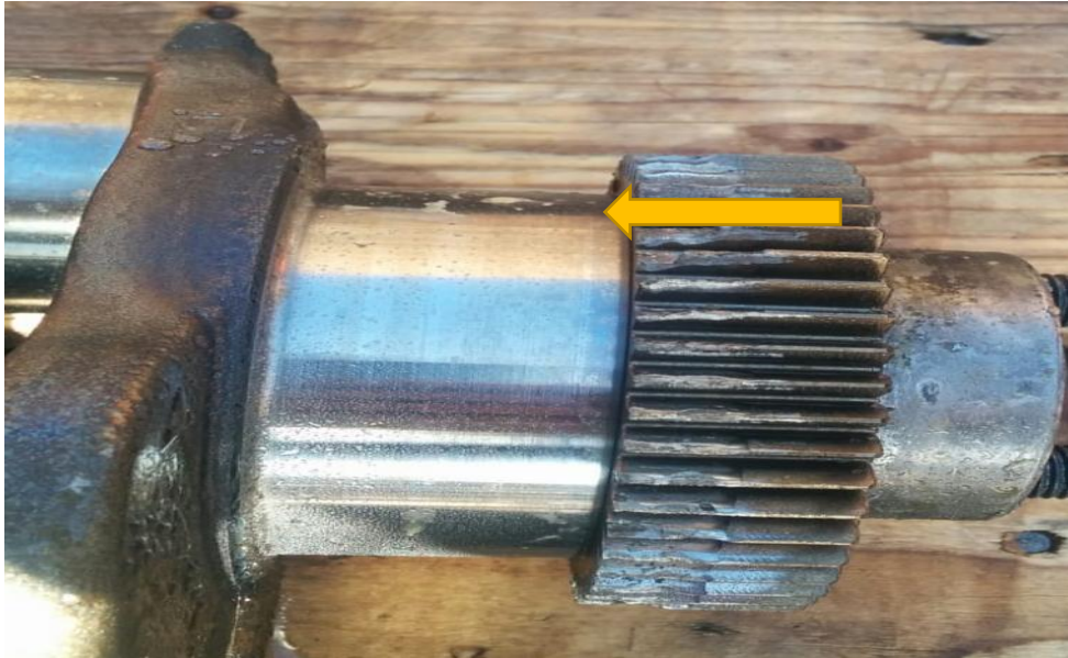
Şekil 2.2.2.1 Aşınmış krank dişlisi
