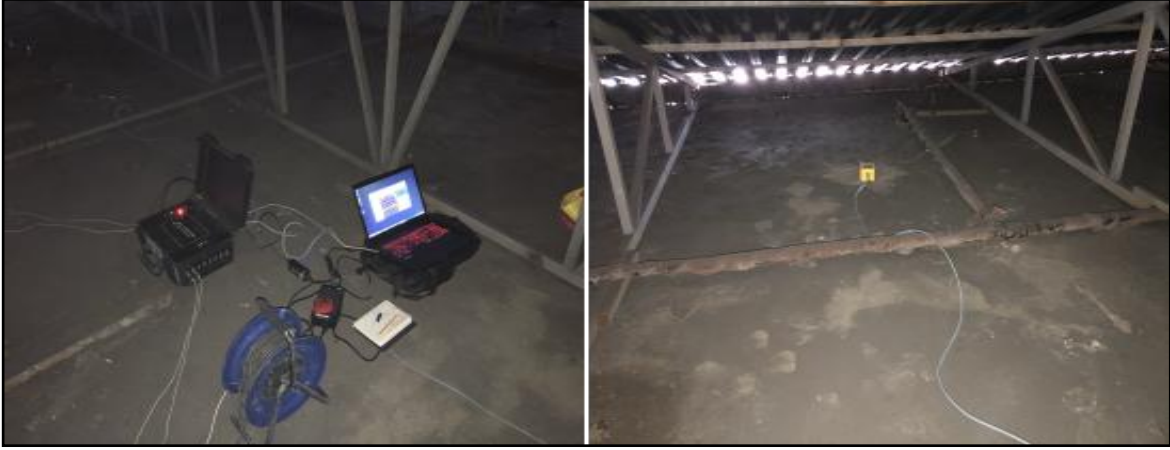
Şekil 2. İvmeölçerler ve veri toplama ünitesi
