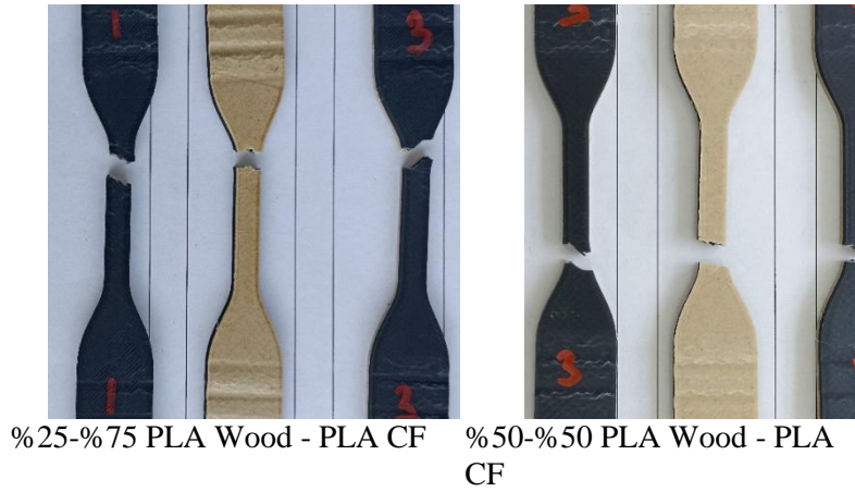
Şekil 10. Çekme sonrası kopma yüzey görünümleri (PLA-CF/PLA Plus).
