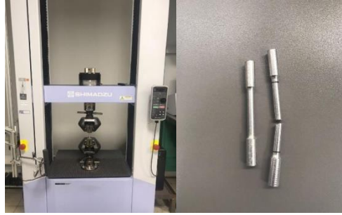
Şekil 6. Çekme testi cihazı ve numune görüntüsü
