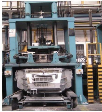
Şekil 4. Alçak Basınç Tezgahının Görünümü
