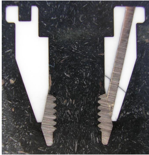
Şekil 2.6. Bakalite alma işleminden sonra zımparalanmış nozul tutucuya ait resim
