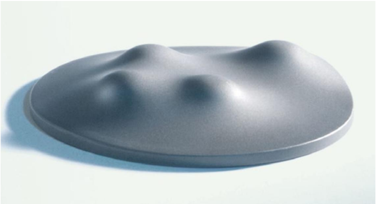
řekil 2.2. Thyssen Krupp firmasının ürettięi TWIP elięinin balistik test sonrası görüntüsü (Nagel, Tomitz, Overra 2014)
