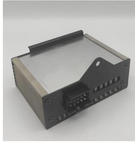
Resim 6: Ön üretimi gerçekleştirilen planlanan tasarıma sahip DC-DC konvertor
