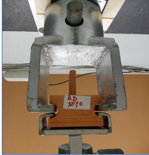
Şekil 4. Deney örneklerin liflere dik çekme deney düzeneği
