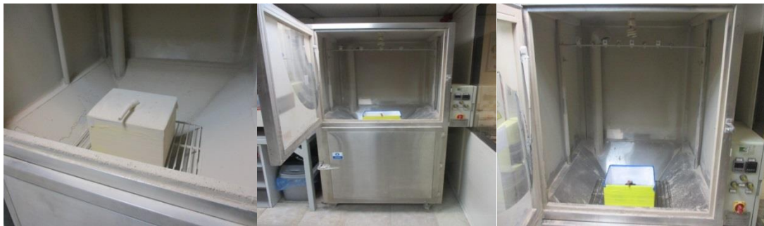
Şekil 7. Toz testinin yapılışı (dust test)
