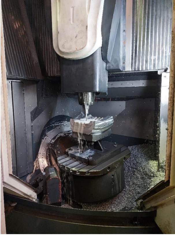
Şekil 3. Desen segmentlerinin CNC tezgâhlarında imalatı
