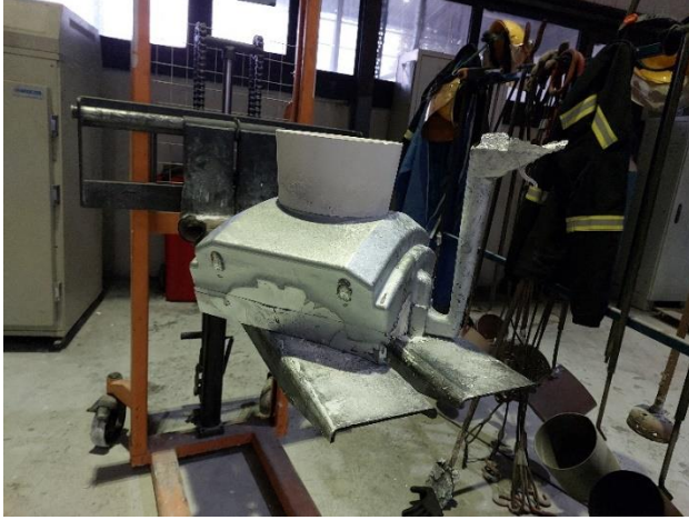
Şekil 4. Desen segmentlerinin döküm işlemi sonrası resmi
