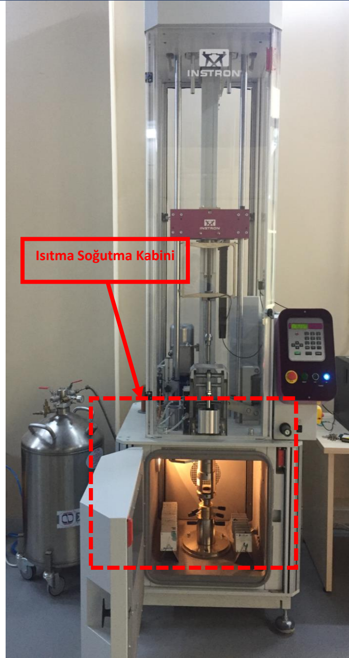
Şekil 2.3. Instron Ceast 9350 darbe test cihazı
