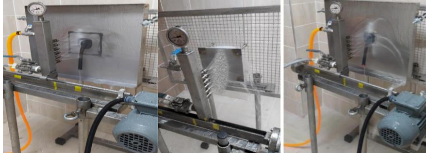
Şekil 4. Su püskürtme test düzeneği (water spray test)
