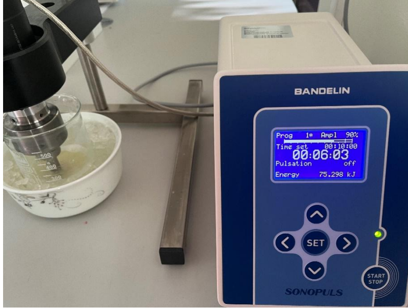
Şekil 2.1. Ultrasonik homojenizatör kullanılarak hazırlanan ağırlıkça %3 oranında SiO 2 nanopartikül takviyeli epoksi.
