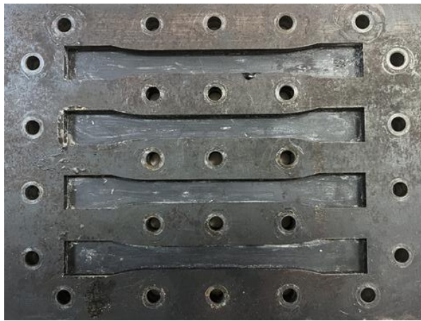
Şekil 2.2. ASTM D638 standardına uygun şekilde tasarlanmış çekme test kalıbı.
