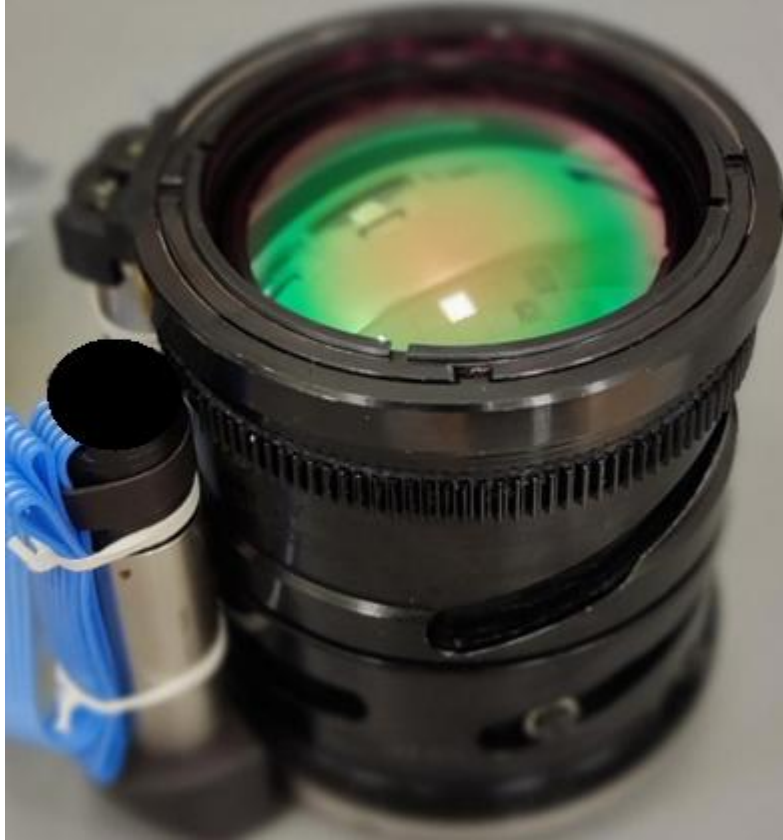
Şekil 2.13 F5,5 sürekli odaklı termal objektif
