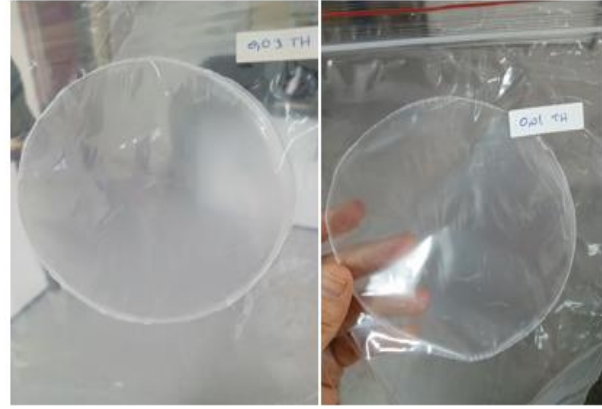
Çözütünün uzaklaştırılması sonucu elde edilen PLA filmleri
