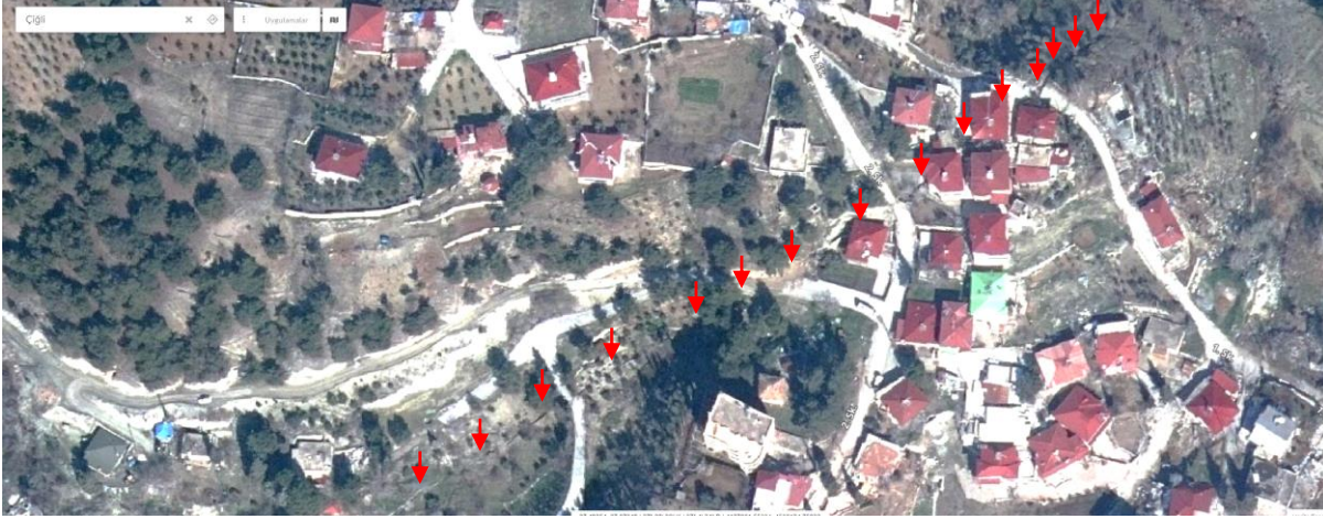
Şekil 5. 06 Şubat 2023 depremleri sonrasında Çığlı Köyü içerisinde geçerek güneybatı yönüne doğru ilerleyen yüzeyel fay izleri
