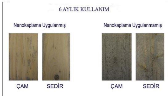
Şekil 2.6:UV Işınlara Karşı Kaplamalı Ve Kaplamasız Malzeme Kullanımı (Yılmaz, 2014)
